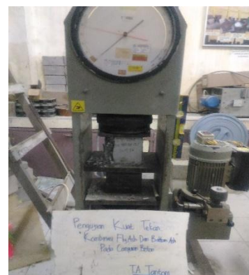
Gambar 2 Pengujian kuat tekan
