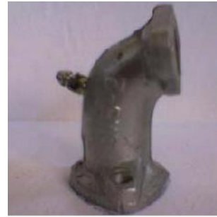
Gambar 6. Intake Manifold Posisi 45° (Mulyono, 2010)
