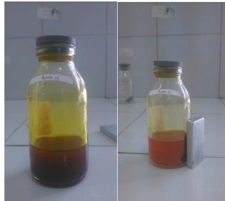
Gambar 1 Pemisahan Katalis Ca_2Fe_2O_5 Menggunakan Magnet
