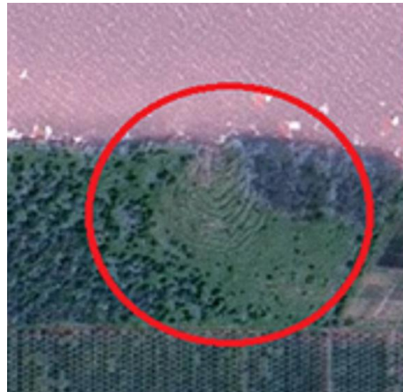
Gambar 3.5 Pola Awal Keruntuhan pada Lereng (Tepi Pantai)
