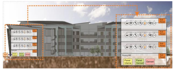
Gambar 26. Skema Jaringan Listrik
