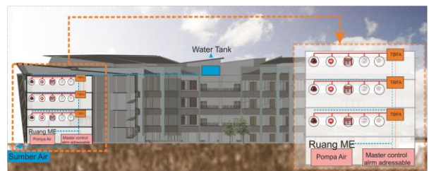
Gambar 29. Skema sistem pencegahan Kebakaran
