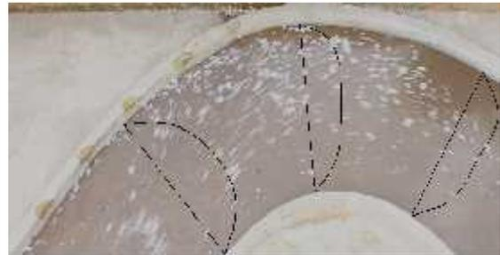
Gambar 17. Distribusi Kecepatan Aliran Permukaan Q<sub>2</sub>T<sub>k</sub>
