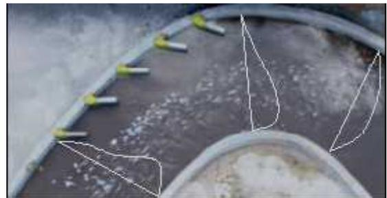
Gambar 18. Distribusi Kecepatan Aliran Permukaan Q<sub>2</sub>S<sub>1</sub>
