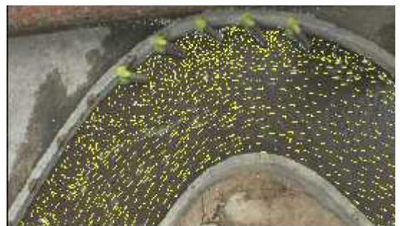
Gambar 32. Pola Aliran Permukaan  $Q_2S_3$
