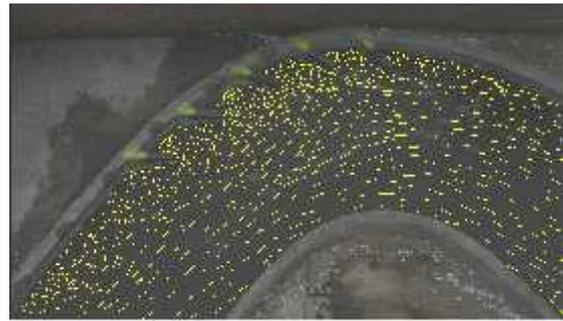
Gambar 35. Pola Aliran Permukaan  $Q_3S_2$
