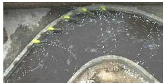
Gambar 19. Distribusi Kecepatan Aliran Permukaan Q<sub>2</sub>S<sub>2</sub>
