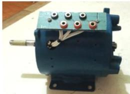
Gambar 3.3 Output generator fasa R,S dan T
