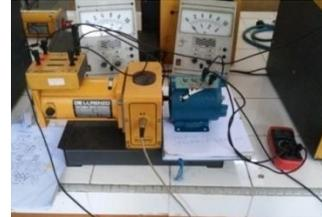
Gambar 4.1 Pengujian Beban Nol
