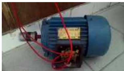
Gambar 4.1 Motor Induksi Tiga Fasa (Sumber : Lab. Konversi Energi Listrik FT UR)
