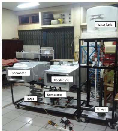
Gambar 1. Foto Alat Uji Mesin Pendingin Siklus Kompresi Uap Hibrida Dengan Katup Ekspansi Jenis Kapiler dan Termostatik
