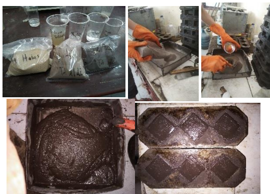
Gambar 1 Bahan Dasar dan Proses Pembuatan Mortar
