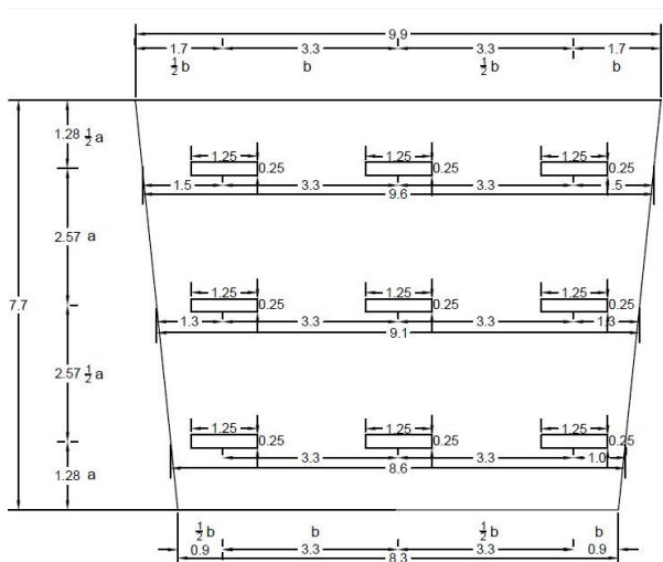
Gambar 4.2 Letak susunan lumener ruangan 301,302,303,316,317,318,319
