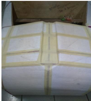
Gambar 10 Sela-sela Styrofoam yang telah ditutupi.
