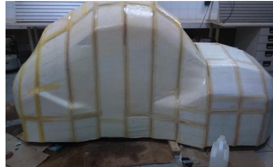
Gambar 12 Cetakan yang telah dilapisi Mirror Glass .
