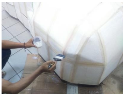
Gambar 11 Proses Pelapisan Polyfoam Coat .
