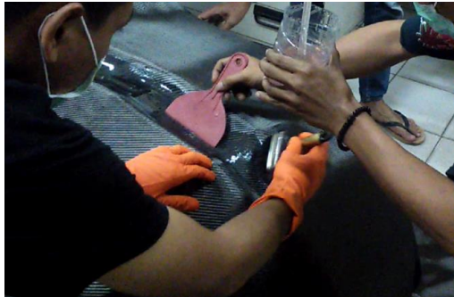
Gambar 15 Proses Hand Lay UP Komposit.
