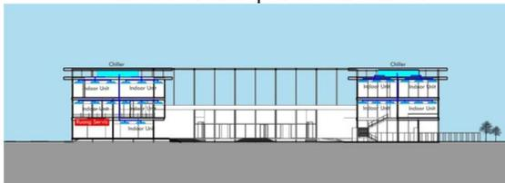
Gambar 14 Penerapan sistem penghawaan
