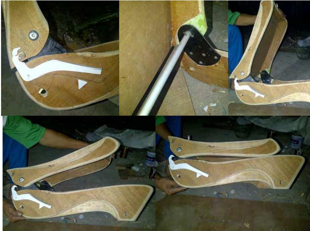
Gambar 8. Proses Pembuatan Mekanisme Lipatan pada Prototip
