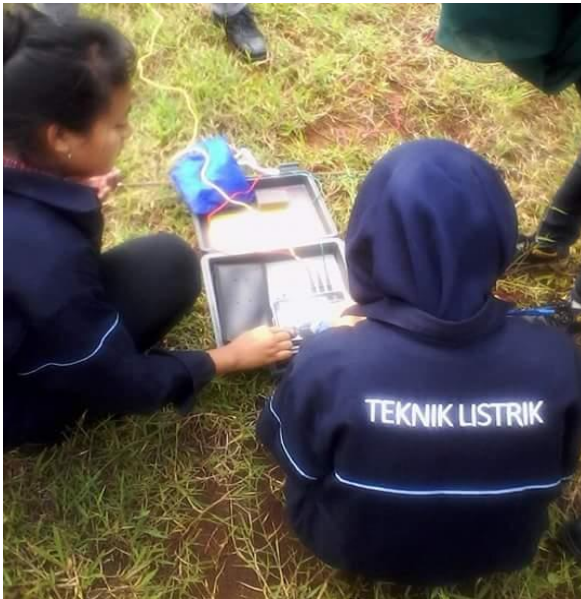
Gambar 10. Pengukuran pentanahan di area cakupan 1
