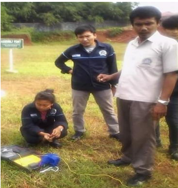
Gambar 11. Pengukuran pentanahan di area cakupan 2
