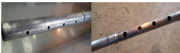
Gambar 2. Nozzle tip sampling probe dengan ukuran diameter lubang 0,125 inch (kiri) dan ukuran diameter lubang 0,25 inch (kanan)
