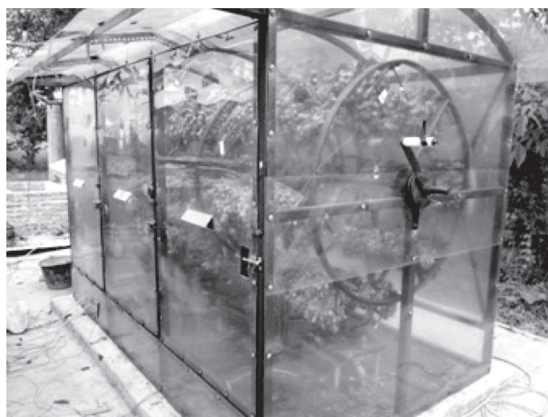
Gambar 2. Prototipe pengering bawang merah (dimensi 2.3 m x 1.3 m x 1.9 m).
