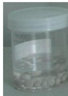
Gambar 11. Uji stabilitas pada asam nitrat
