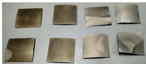
Gambar 3.14 Material uji setelah direndam larutan KOH konsentrasi 3M, 4M, 5M dan 6M
