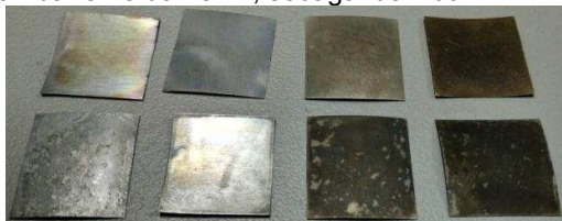
Gambar 3.13 Material uji setelah direndam larutan KOH konsentrasi 0,1M, 0,5M, 1M dan 2M
