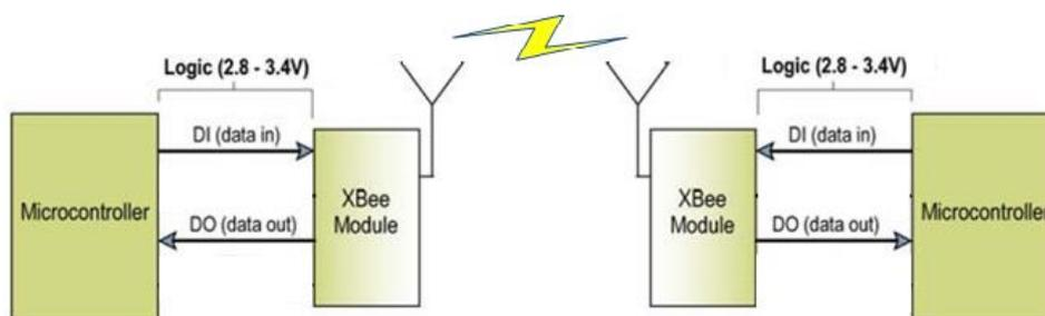
Gambar 3. Konfigurasi X-Bee dengan Mikrokontroler[4]
