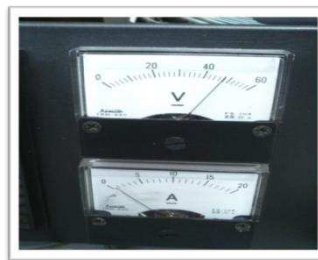
Gambar 7. Pengukuran Arus Masuk pada Power Amplifier
