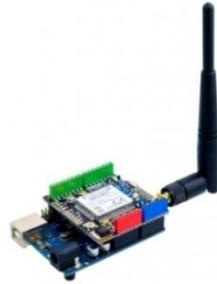
Gambar 4. Arduino uno dengan Modul *Wireless* WizFi210[10]
