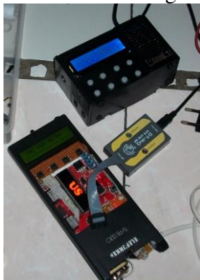
Gambar 8 Prototype IR Kwh meter dan simulasi data Kwh meter
