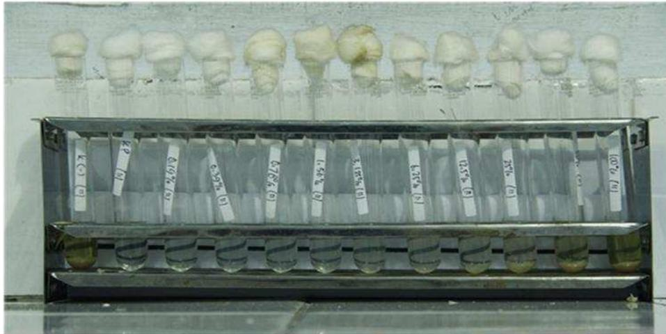
Gambar 1. Hasil Pengujian Penentuan Konsentrasi Hambat Minimum Antibakteri Infusa Daun kesum dengan Metode Makrodilusi
