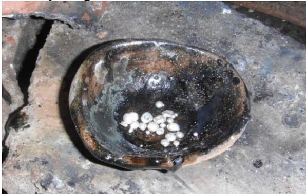
Gambar 2. Perak yang Dihasilkan dari Metode Pengendapan dengan NaOH Setelah Dilakukan Pembakaran atau *Burning*.
