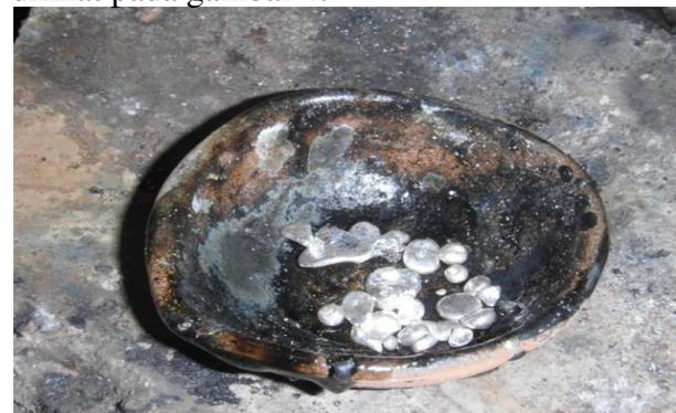
Gambar 4. Perak yang Dihasilkan dari Metode Pengendapan dengan  $\text{Na}_2\text{S}$  Setelah Dilakukan Pembakaran atau *Burning*.
