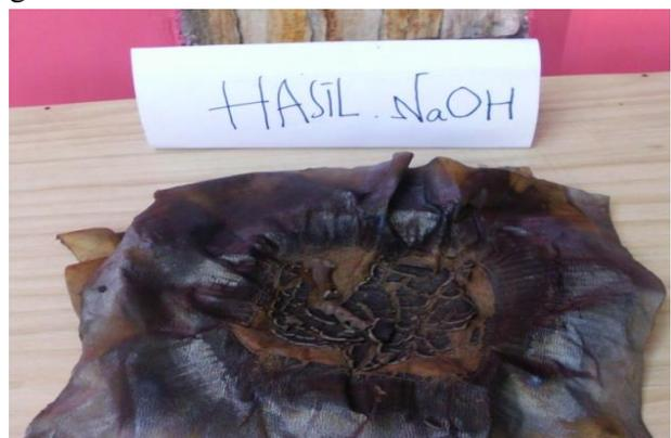
Gambar 1. Pengambilan Endapan yang Dihasilkan dari Metode Pengendapan dengan NaOH.
