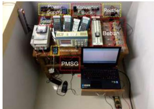
**Gambar 3.** Perangkat sistem turbin angin
