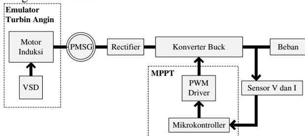
**Gambar 2.** Diagram sistem turbin angin dengan MPPT
