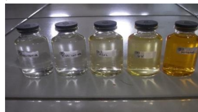
Gambar 7. Warna sampel hasil fotodegradasi selama 12 jam: (a) Lapisan tipis nanokomposit TiO 2 /CNT refluks, (b) Lapisan tipis nanokomposit TiO 2 /CNT non refluks, (c) Lapisan tipis TiO 2 (d) UV (e) control
