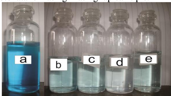
Gambar 4 Hasil fotokatalis selama 4 jam larutan methylene blue 10ppm dengan variasi temperatur sintering
