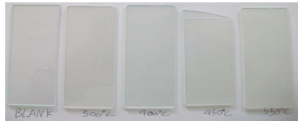
Gambar 1 Lapisan ZnO pada substrat kaca dengan variasi temperatur sintering
