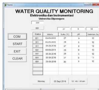
Gambar 10 Sistem antarmuka pembacaan sensor Setelah mendapatkan hasil pembacaan sensor kemudian disimpan ke dalam basis data MySQL .
