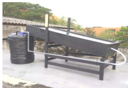
Gambar 2. Instalasi Pengujian Kolektor Surya Dengan Penambahan External Helical Fins
