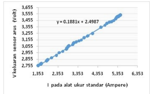
Gambar 3. Grafik hubungan V_{out} ACS712 terhadap alat ukur arus
