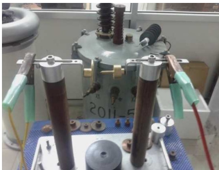
Gambar 8. Pengujian kombinasi elektrode jarum dan datar kuningan
