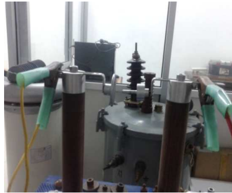
Gambar 10. Pengujian kombinasi elektrode tumpul dan datar aluminium
