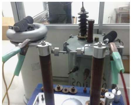
Gambar 9. Pengujian kombinasi elektrode jarum dan tumpul baja
