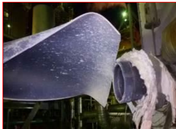
Gambar 2. Kegagalan Pecah pada Sambungan Longitudinal
