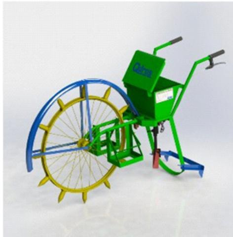
Gambar 1. Rancangan Desain Q-Dros (*Quick Drop Seeder*)
