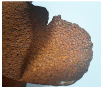
Gambar 3 Permukaan dalam pipa desuperheater spray
