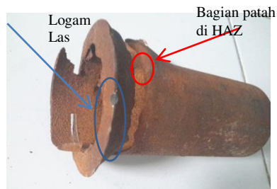
Gambar 2 Patahan yang terjadi pada pipa desuperheater spray
