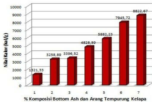
Gambar 4.4 Diagram Nilai Kalor Briket Campuran Bottom Ash dan Arang Tempurung Kelapa
