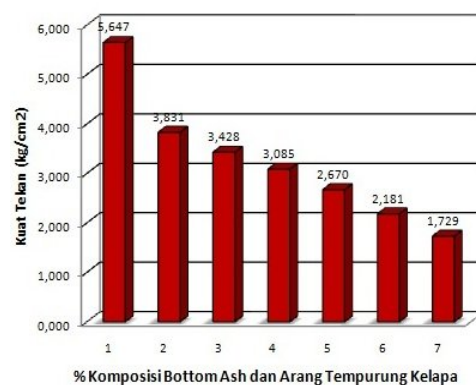
Gambar 4.3 Diagram Kuat Tekan Briket Campuran Bottom Ash dan Arang Tempurung Kelapa
