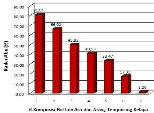
Gambar 4.2 Diagram Kadar Abu Briket Campuran Bottom Ash dan Arang Tempurung Kelapa
