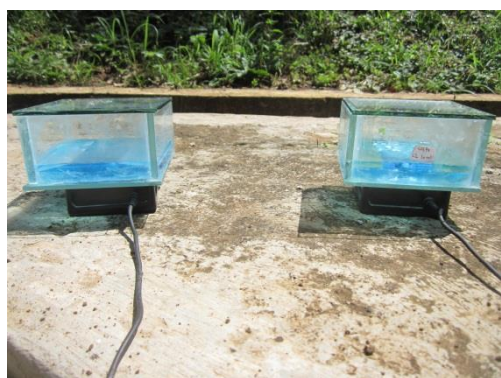
Gambar 5. Pengujian fotodegradasi zat warna methylene blue
