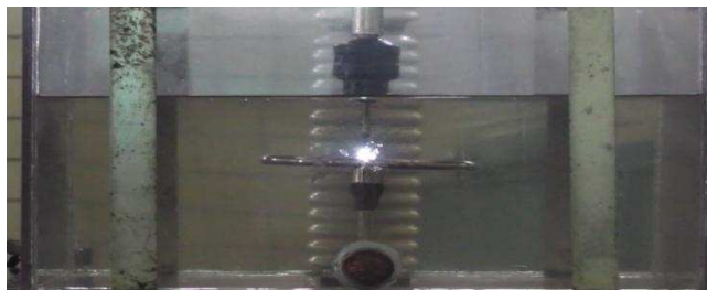
Gambar IV.1. Tampak korona pada elektroda jarum berdiameter ujung jarum 25 \mu\text{m} pada jarak sela 0.5 cm
