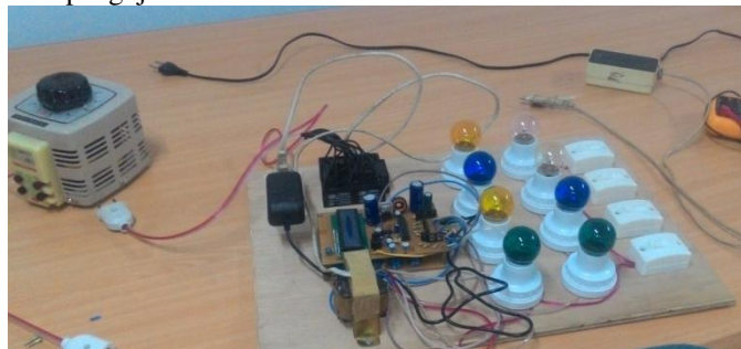
Gambar 9. Rangkaian Keseluruhan Pengendali Beban Pengatur Otomatis Terhadap Perubahan Beban
