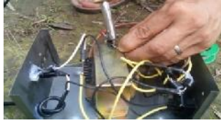
Gambar 8 Tahapan penyolderan komponen Setelah setiap komponen elektronika terpasang dengan baik maka dilakukan proses penyolderan.
