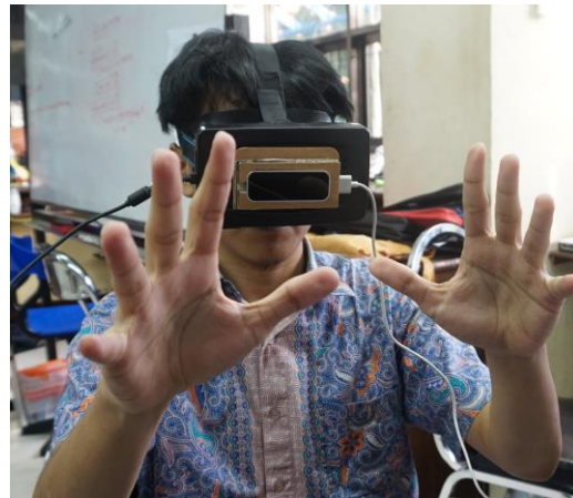
Gambar. 4. Pengguna mengenakan HMD yang telah dimodifikasi untuk penambahan Leap Motion pada sisi depan.
