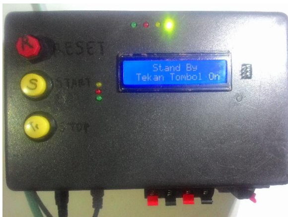
Gambar 3. Modul sistem proteksi arus lebih motor induksi tiga fasa berbasis mikrokontroler ATmega16 .
