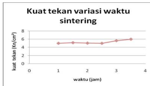
Gambar 7. Grafik Kuat Tekan Blok Synroc Limbah Variasi Waktu Sintering
