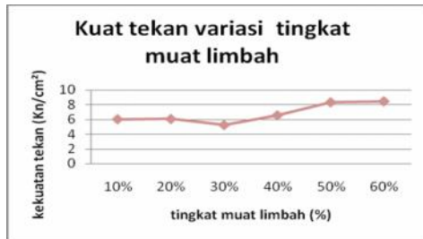
Gambar 11. Grafik Kekuatan Tekan Blok Synroc Limbah Variasi Tingkat Muat Limbah
