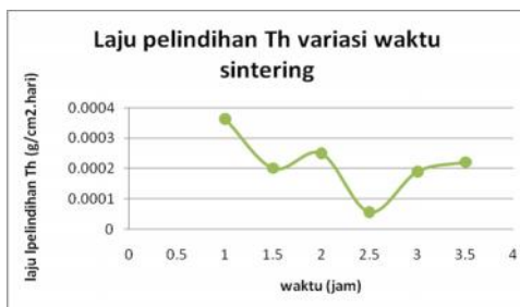
Gambar 9. Grafik Laju Pelindihan Unsur Thorium Pada Blok Synroc Limbah Variasi Waktu Sintering
