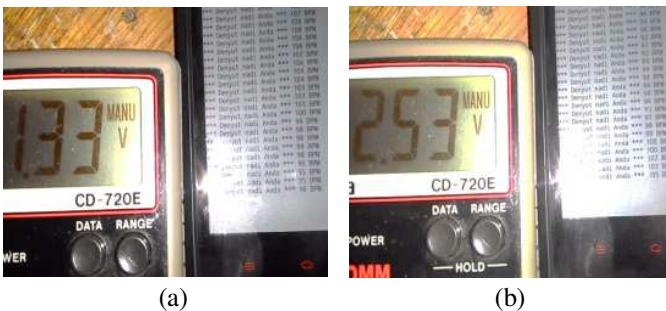
Gambar 13. Pengukuran Respons Tegangan Input Sensor. (a) Tegangan Input Naik; (b) Tegangan Input Turun
