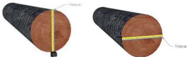
Gambar 1. Pengukuran diameter kayu konvensional menggunakan alat bantu meteran. Tampak gambar kiri pengukuran diameter ujung, dan tampak kanan pengukuran diameter pangkal
