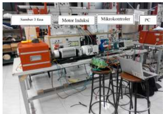
Gambar .2. Pengujian Sistem di Laboratorium.
