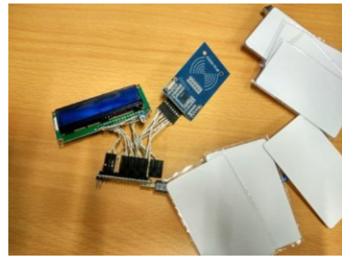
Gambar 13 Konektifitas Antara LCD, Arduino Nano V3 dan RFID RC522
