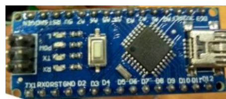
Gambar 9 Bentuk Fisik dari Arduino Nano Versi 3.0
