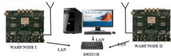
Gambar 3.2 Konfigurasi Sistem Komunikasi dengan WARP
