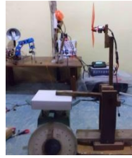
Gambar 4.1. Pengujian Daya Angkat Motor
