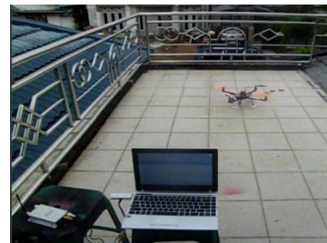
Gambar 4.9. Sistem Pemantauan dengan Kamera Wireless yang Dihubungkan Pada Laptop
