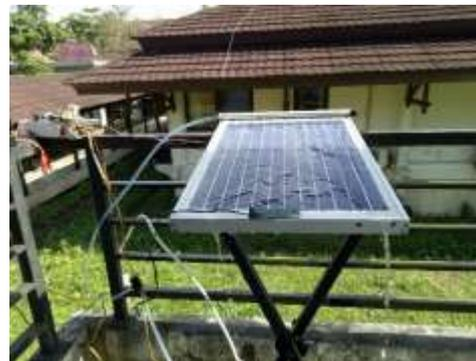
Gambar 2. Panel surya dengan *water cooling system*
